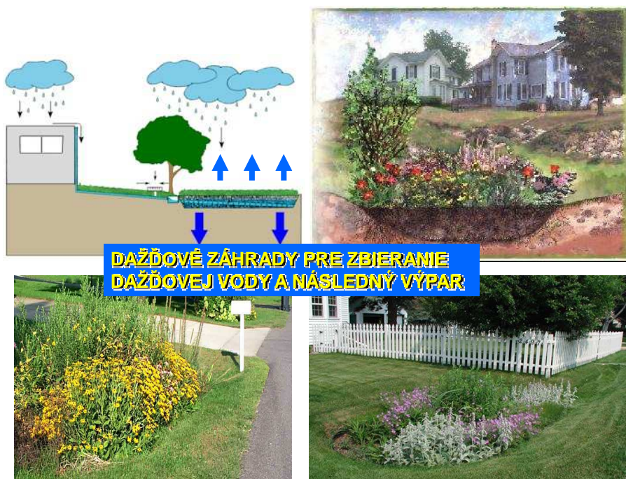
Obr.: Schéma princípu dažďovej záhrady a príklady použitia v praxi, zbieranie dažďovej vody z administratívnej budovy, športového centra a zo spevnených plôch 38,39,40,41 .
