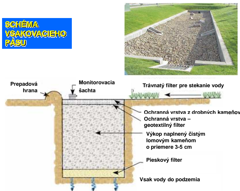
Obr.: Schéma vsakovacieho pásu s technickým popisom vrstiev pásu 23
